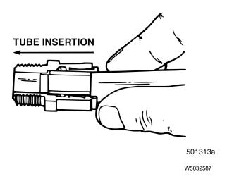
Fig. 16 Insert Tube
