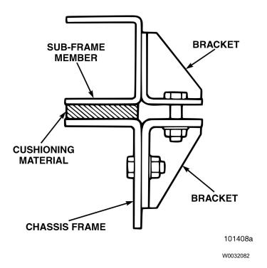
Fig. 12 Bracket-Style Rigid Mount
