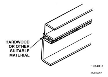
Fig. 7 Sub-frame Sill Plate
