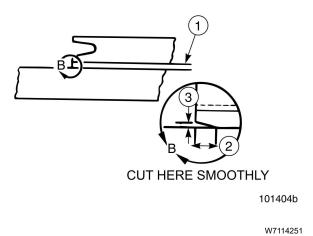
Fig. 8 Sill Plate Chamfer
